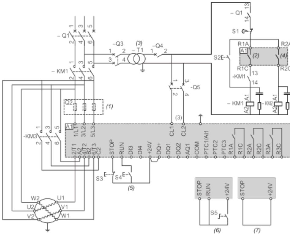
(1): Instalación de fusibles de acción rápida adicionales para mejorar la coordinación de tipo 2 de acuerdo con la norma IEC 60947-4-2.
